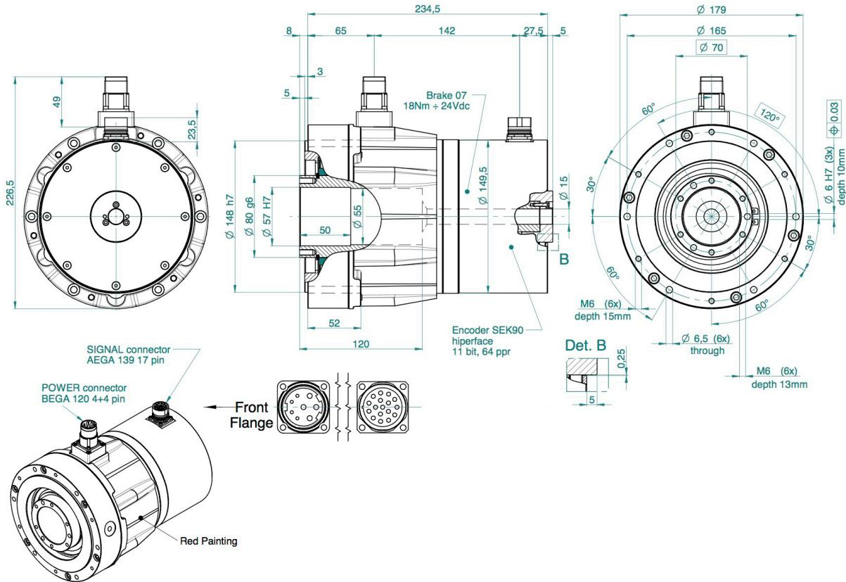
**SKA DDR 148 POWER PACK HOLLOW SHAFT AND BRAKE reference drawing 115**
